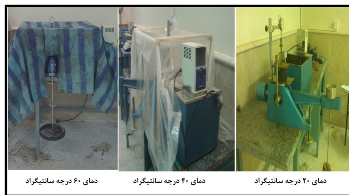
شکل ۱. دستگاه تحکیم به همراه تجهیزات جهت حفظ دمای مورد نظر
