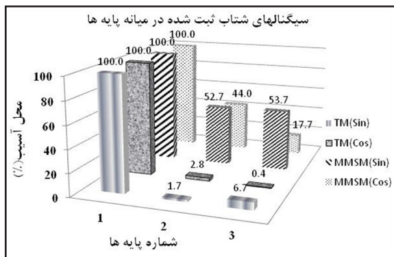
شکل ۱۶. تشخیص آسیب بر اساس سیگنال‌های شتاب ثبت شده در میانه پایه‌ها
