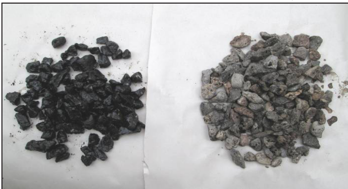
شکل ۸. دوام اندود مصالح برای نمونه F (سمت راست بعد از شست و شو)
