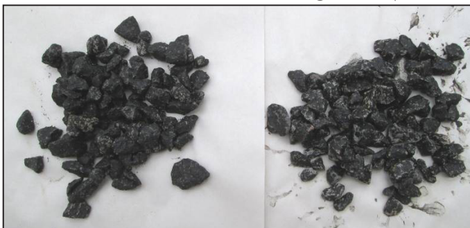
شکل ۷. دوام اندود مصالح برای نمونه E (سمت راست بعد از شست و شو)
