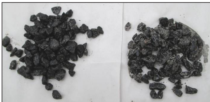
شکل ۶. دوام اندود مصالح برای نمونه B (سمت راست بعد از شست و شو)
