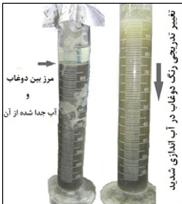
شکل ۱۰. آب اندازی شدید دوغاب غلیظ همراه روان کننده (راست) آب اندازی دوغاب‌های بدون روان کننده (چپ)
