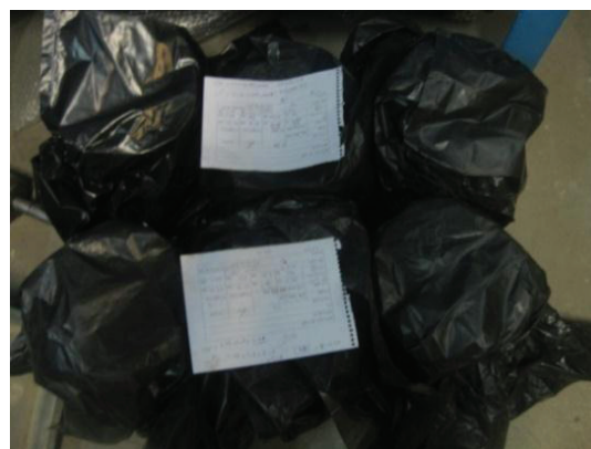
شکل ۴. پوشش گونی نخی و نایلون برای عمل آوری در ۲۴ ساعت ابتدایی ساخت مخلوط
