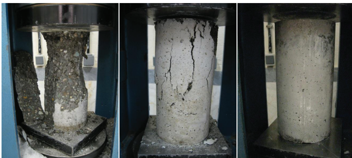
شکل ۶. آزمایش مقاومت فشاری تک محوری
