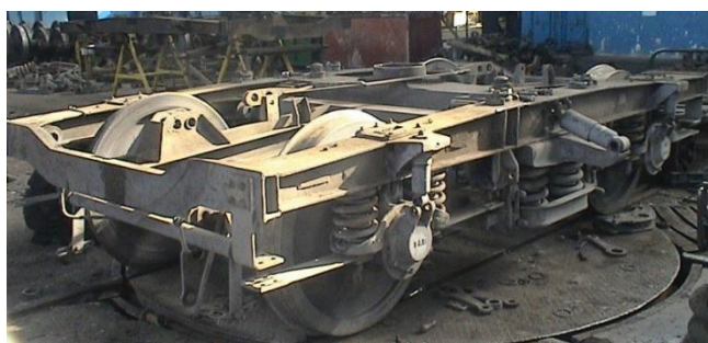
شکل ۹. نمای بوژی دو محوره MD36 با متعلقات
