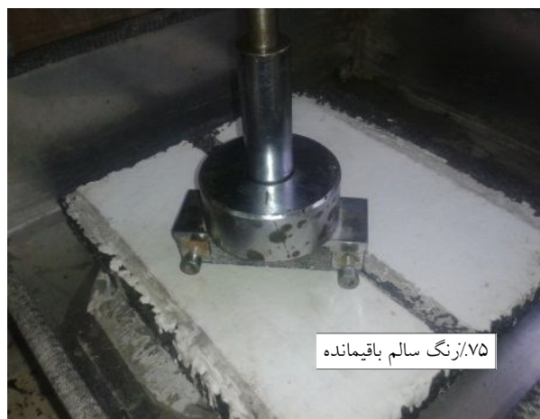
شکل ۳. نحوه اعمال سایش توسط دستگاه WTAT
