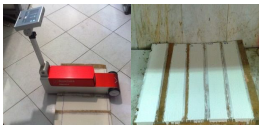
الف: نمونه های تهیه شده برای انجام آزمایش بازتابندگی سنجنش بازتاب نور ب: نحوه قرار گیری نمونه در دستگاه
