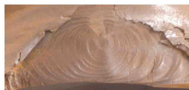
شکل ۷. دو نمونه از چرخ‌های وامانده در اثر رشد ترک زیرسطحی [۲۴]
