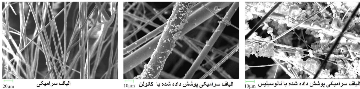
شکل ۸. عکس میکروسکوپی (a) الیاف سرامیکی (b) الیاف سرامیکی پوشش داده شده با کائولن (c) الیاف پوشش داده شده با نانوسیلیس
