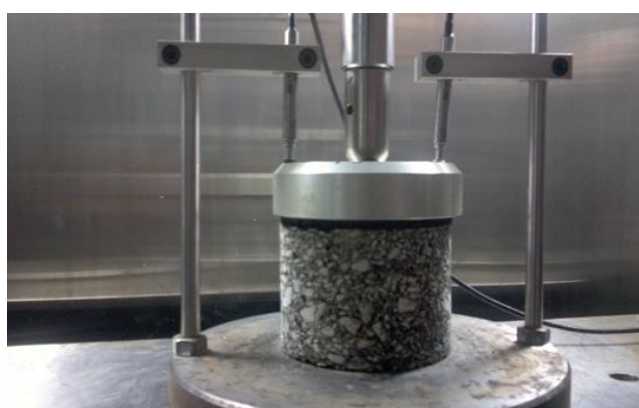
شکل ۳. نمونه تحت آزمایش خزش دینامیکی
