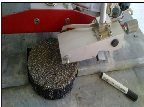
شکل ۳. اندازه گیری عدد اصطکاکی نمونه های آسفالتی
