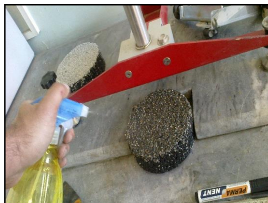
شکل ۵. اسپری آب جهت تعیین عدد اصطکاک سطح در حالت تر
