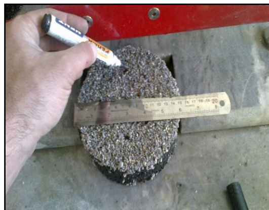
شکل ۴. علامتگذاری میزان طولی که لغزنده پاندول باید طی کند
