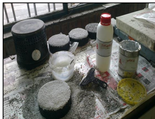
شکل ۲. اجرای لایه اصطکاک بالا روی نمونه های آسفالتی
