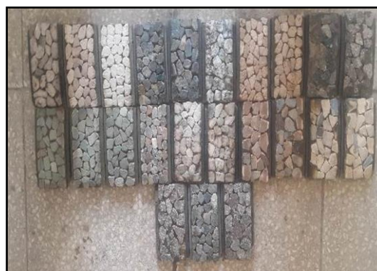
شکل ۶. نمونه‌های سایشی ساخته شده از انواع مصالح سنگی
