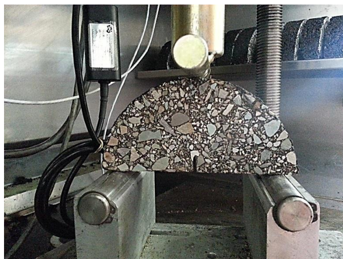
شکل ۷. نمونه‌های SCB در آزمون مکانیک شکست نیم‌دیسک خمشی
