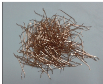
شکل ۲. الیاف فولادی مورد استفاده
