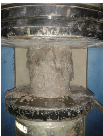
شکل ۳. آزمایش مقاومت فشاری
