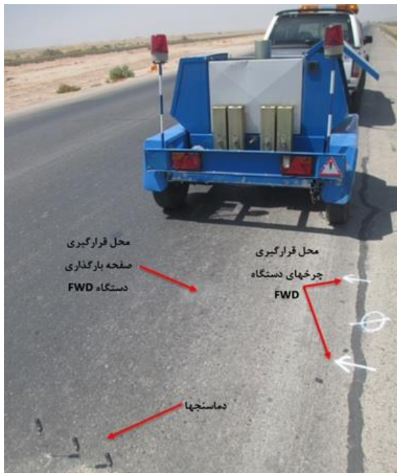
شکل ۲. آزمایش FWD همراه با اندازه‌گیری دمای عمق لایه آسفالتی در یک سایت روسازی
