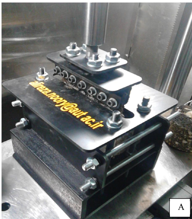
شکل ۴: دستگاه انجام آزمایش Pullout به صورت متصل (A) و جدا (B) از دستگاه UTM
