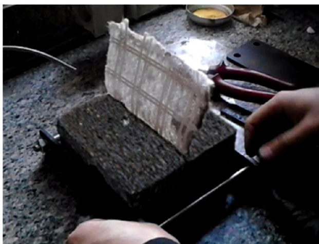
شکل ۳. نحوه ساخت نمونه‌های آزمایش بیرون کشش
