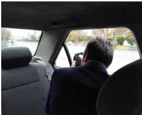
شکل ۴. برداشت سرعت از طریق سرعت سنج دستی توسط فرد اندازه گیر درون خودرو
