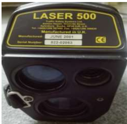
شکل ۴. برداشت سرعت از طریق سرعت سنج دستی توسط فرد اندازه گیر درون خودرو
