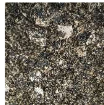
(ج) عکس اصلی بعد از جوشاندن بر روی سنگدانه عمل‌آوری شده
