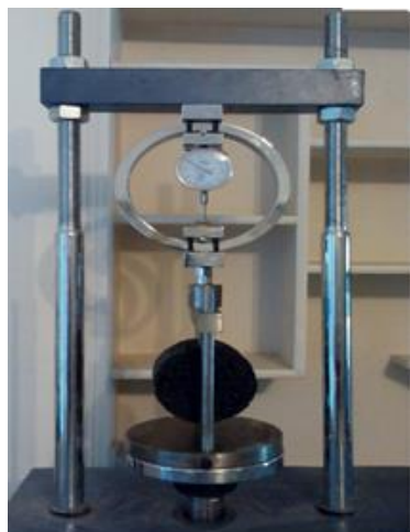
شکل ۴. آزمایش کشش غیر مستقیم
