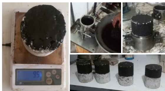
شکل ۲. مراحل ساخت نمونه‌های مرکب (بتنی اصلاح شده- آسفالتی)
