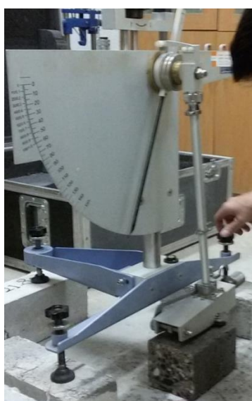
شکل ۸. نحوه انجام آزمایش آونگ انگلیسی
