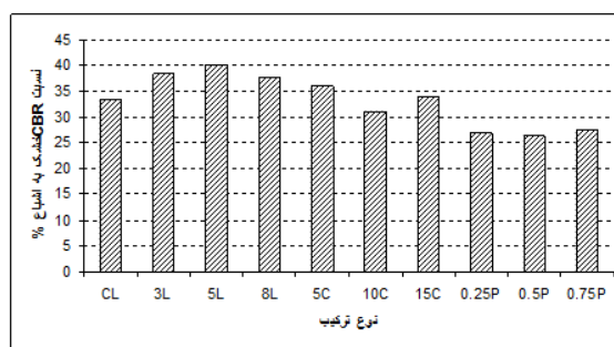
شکل ۱۶. نسبت CBR اشباع به CBR خشک برای ترکیبات مختلف
