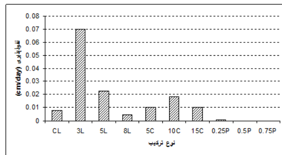
شکل ۲۳. مقدار نفوذپذیری برای ترکیبات مختلف خاک تثبیت شده
