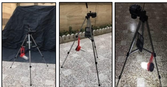
شکل ۳. سخت‌افزار برداشت تصاویر خرابی در شرایط کنترل شده
