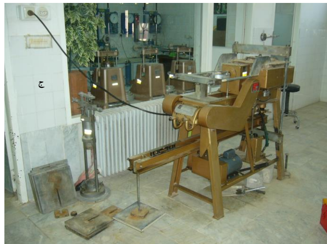
شکل ۹. نحوه مسلح سازی نمونه‌های مورد مطالعه در دستگاه برش مستقیم، الف- یک لایه ژئوگرید، ب- دو لایه ژئوگرید، ج- دستگاه برش مستقیم مورد استفاده در تحقیق حاضر
