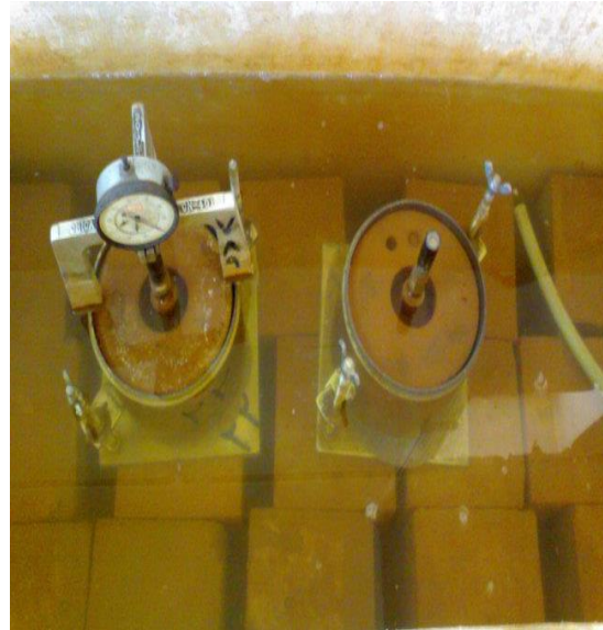
شکل ۸. انجام آزمون نسبت باربری کالیفرنیا در حالت اشباع بر روی نمونه‌های مورد مطالعه
