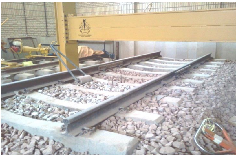
شکل ۷. پانل خط آماده شده برای آزمایش
