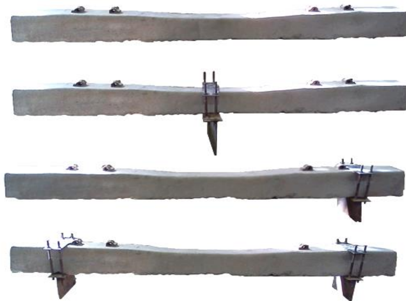
شکل ۶. تراورس های انتخاب شده به همراه صفحات مهاري در ۴ سری آزمایشات پیش بینی شده
