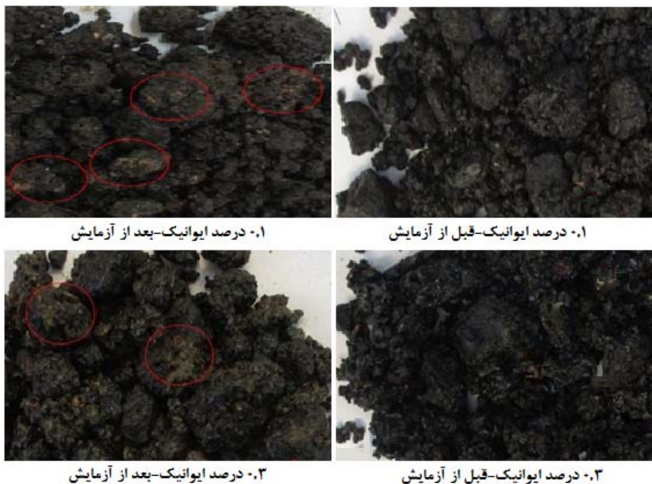
شکل ۸. نمونه‌های آسفالتی حاوی ایوانیک قبل و بعد از آزمایش جوشان تگزاس
