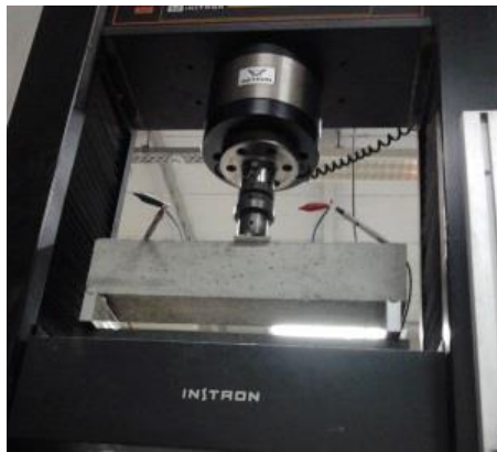
شکل ۳. انجام آزمایش تیرچه خمشی سه نقطه‌ای
