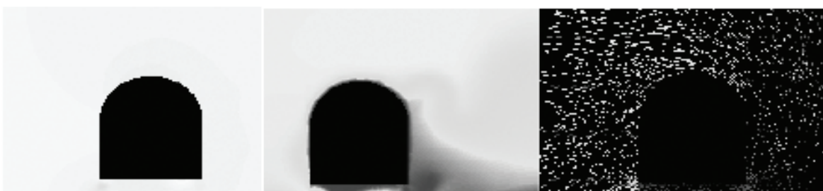
شکل ۷. تصویر سطوح فشار، گردابه بادپناه و میدان سرعت برای قطار پاریسی در
