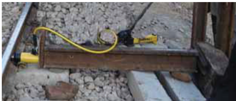
شکل ۳. نحوه استقرار جک در محل اعمال نیرو
