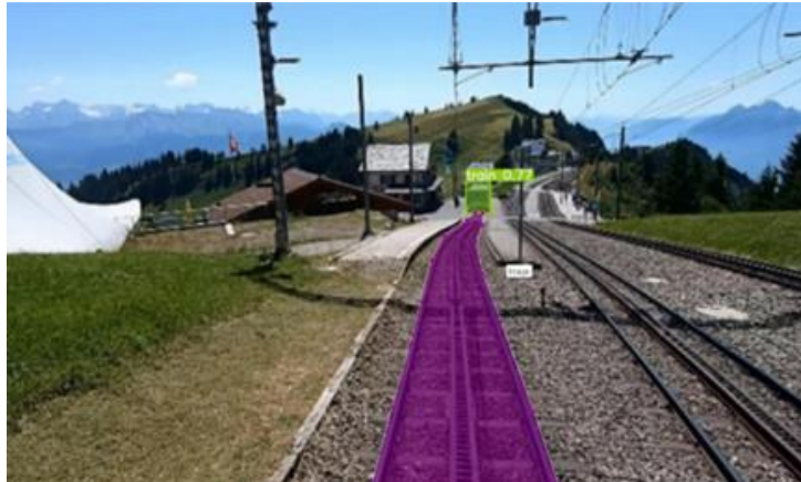
شکل ۱۶. قطاری که روی ریل اصلی به سمت قطار مورد نظر در حال حرکت است و الگوریتم در حالت کلی توانایی تشخیص آن را بعنوان مانع ندارد.
