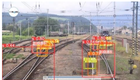
شکل ۱۴. یک نمونه خطای الگوریتم در حالتی که دو سوزن بسیار نزدیک به هم هستند.
