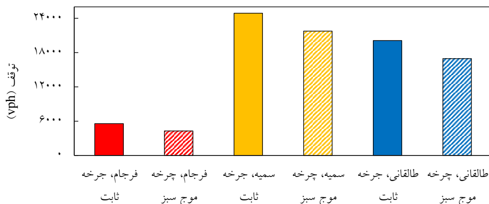
شکل ۲. تعداد کل توقف در خیابان‌های فرجام، سمیه و طالقانی برای حالت چرخه ثابت و حالت چرخه موج سبز چراغ راهنمایی
