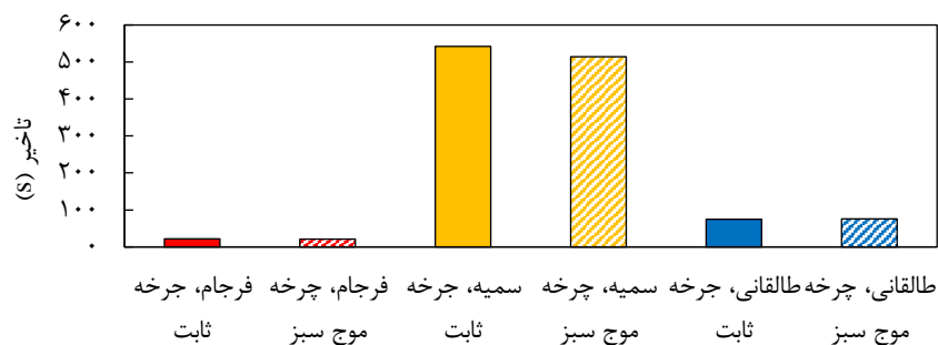
شکل ۴. میانگین تأخیر در خیابان‌های فرجام، سمیه و طالقانی برای حالت چرخه ثابت و حالت چرخه موج سبز چراغ راهنمایی
