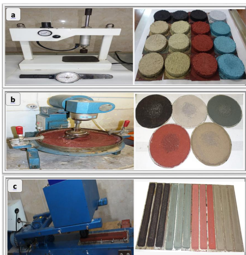
شکل ۳. نمونه‌های اسلاری سیل رنگی: (a). WCT، (b). WTAT و (c). LWT
