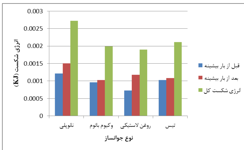
شکل ۸. انرژی شکست قبل و بعد از بار بیشینه برای مخلوط‌های آسفالتی بازیافتی حاوی ۵۰ درصد تراشه آسفالت
