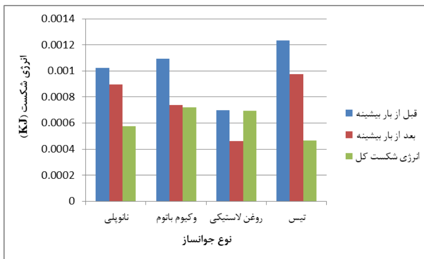
شکل ۹. انرژی شکست قبل و بعد از بار بیشینه برای مخلوط‌های آسفالتی بازیافتی حاوی ۷۵ درصد تراشه آسفالت
