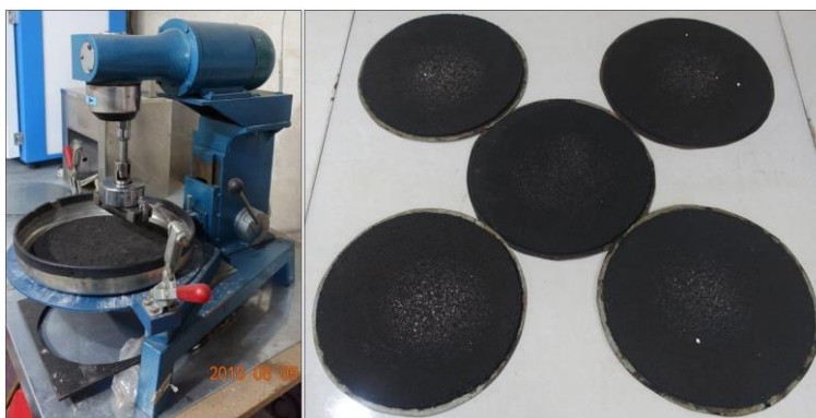
شکل ۴. نمایی از دستگاه آزمایش WTAT و نمونه‌های ساخته‌شده این آزمایش
