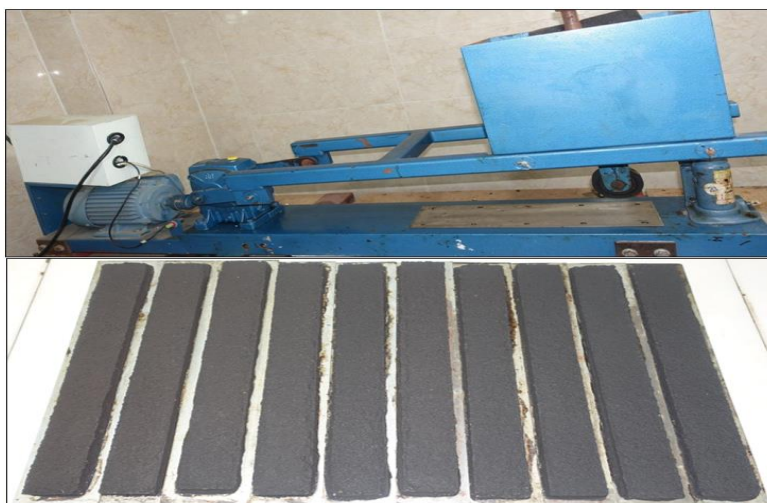
شکل ۵. دستگاه چرخ بارگذاری و نمونه‌های ساخته شده
