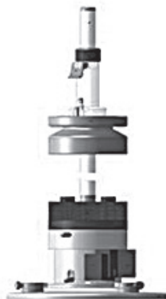
شکل ۲. دستگاه افت و خیز سنج ضربه‌ای سبک (LWD)
