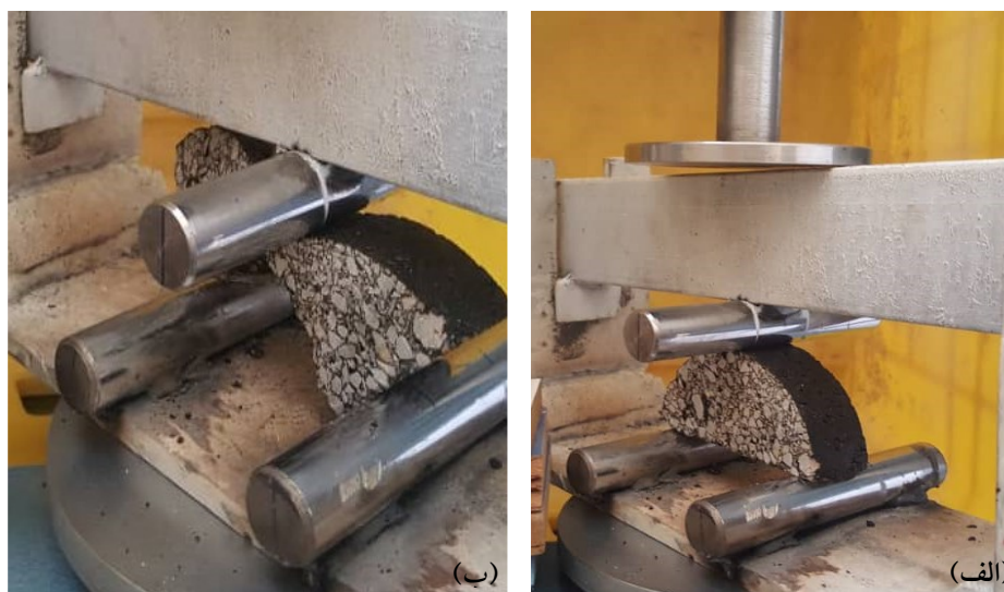
شکل ۳. نمونه نیم‌دایره‌ای: (الف) قبل از بارگذاری؛ (ب) بعد از بارگذاری
