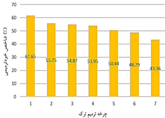
شکل ۷. شاخص خودترمیمی مخلوط آسفالتی حاوی ۶۰ درصد سرباره فولاد
