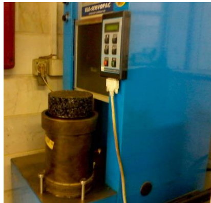
شکل ۲. آماده‌سازی نمونه و طرح اختلاط به وسیله دستگاه متراکم کننده چرخشی سوپرپیو
