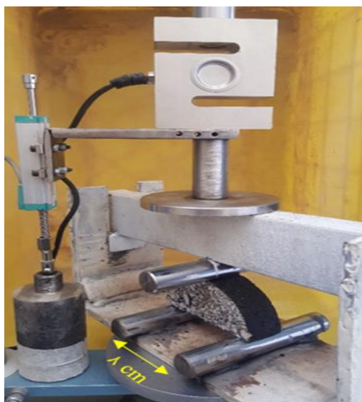
شکل ۲. آزمایش خمش سه نقطه‌ای با دستگاه تک محوری
