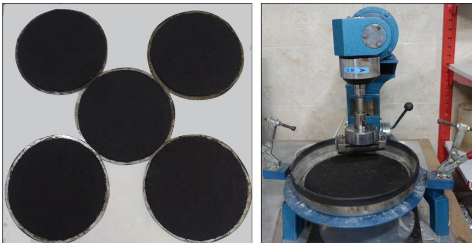
شکل ۲. نمایی از دستگاه آزمایش WTAT و نمونه‌های ساخته شده این آزمایش
