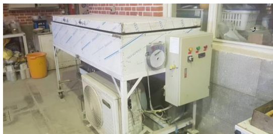
شکل ۲. تصاویر دستگاه‌های مورد استفاده در تحقیق حاضر، الف- تعیین سرعت امواج اولتراسونیک، ب- تعیین مقاومت فشاری، ج- تعیین مقاومت کششی غیر مستقیم، د- تعیین مقاومت خمشی، و- بررسی رفتار نمونه در سیکل های ذوب و یخبندان
