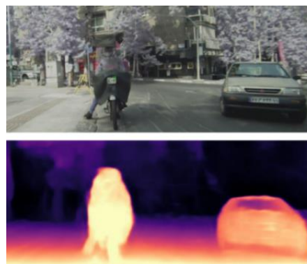
شکل ۱۱. تصویر عمق تولید شده توسط پارامترهای بهبود یافته‌ی مدل Monodepth2 بر روی تک تصویر اخذ شده از موتورسیکلت
