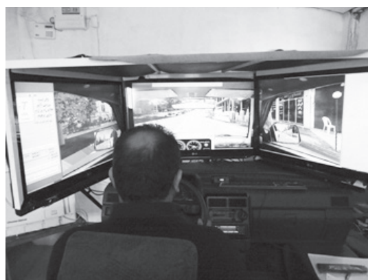
شکل ۴. نمای کلی از دستگاه شبیه ساز رانندگی یک شرکت ایرانی
