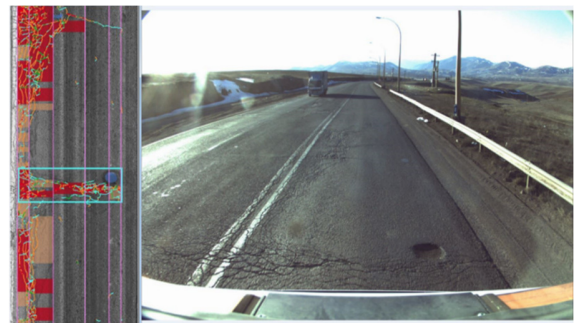
شکل ۲. نمایی از تصاویر واقعی و پردازش شده دستگاه LCMS
