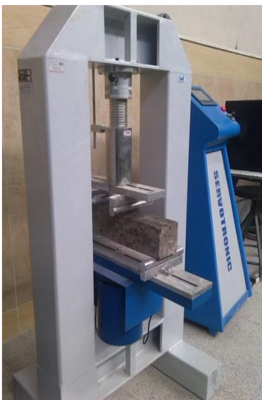
شکل ۷. نحوه تنظیم دستگاه UTM و نمونه بتن
