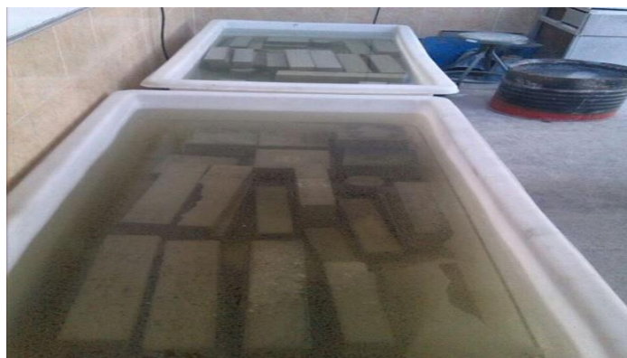
شکل ۳. عمل‌آوری نمونه‌های بتنی در آب آهک
