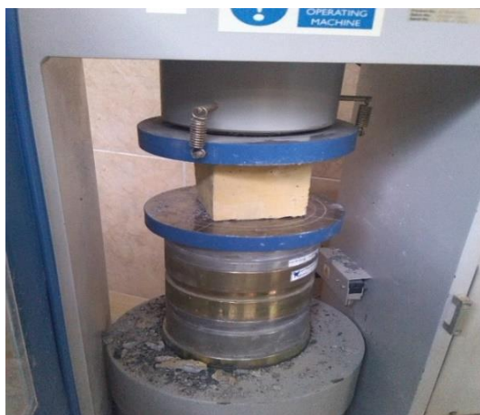
شکل ۴. نحوه تنظیم دستگاه آزمایش مقاومت فشاری
