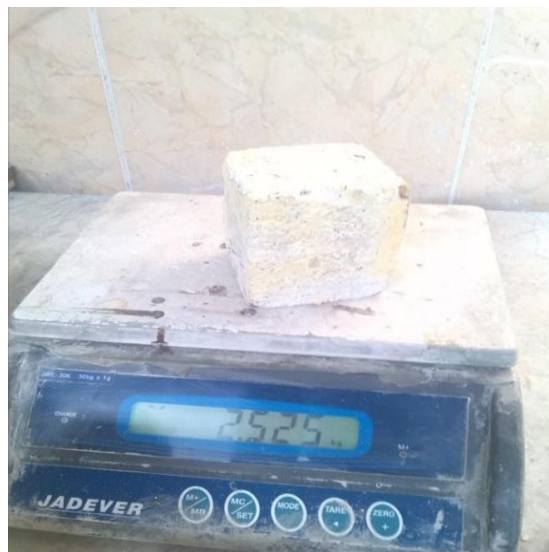
شکل ۵. وزن نمونه‌ها بعد از قرارگیری در محلول‌های شیمیایی
