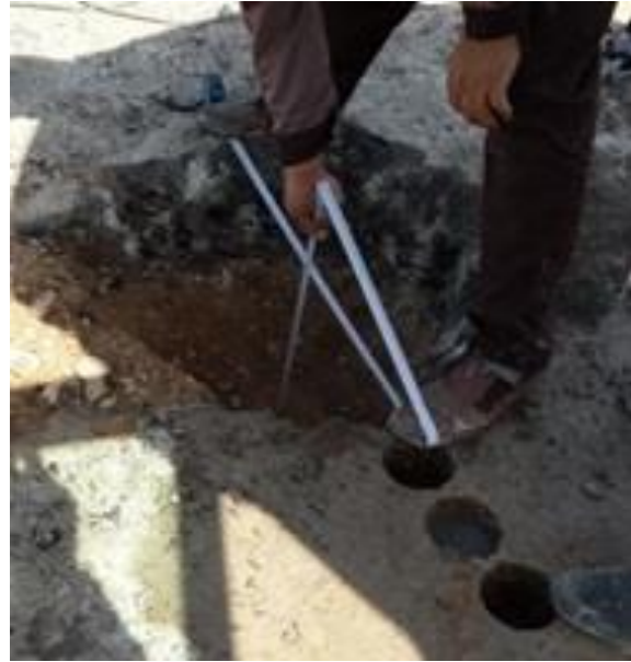
شکل ۳. انجام سونداژ و مغزه‌گیری در یک سایت روسازی
