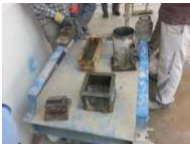
شکل ۵. ساخت نمونه‌ها بر روی میز لرزان
