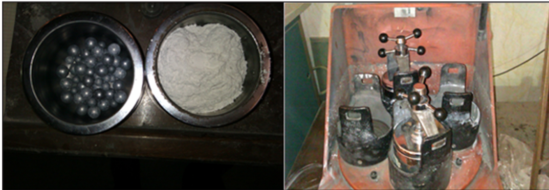
شکل ۱. آسیاب گلوله‌ای سیاره‌ای مورد استفاده
