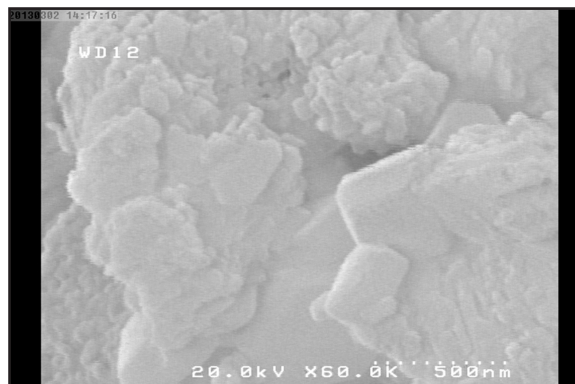
شکل ۲. تصویر SEM ابعاد آهک هیدراته قبل از عملیات آسیاب
