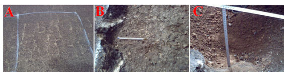
شکل ۱۸. گمانه حفر شده در قطعه ۲، کیلومتر ۳۲+۲۰۰ (A): سطح آسفالت رویه، (B): سطح لایه بازیافتی، (C): سطح بستر، سال ۱۳۸۶
