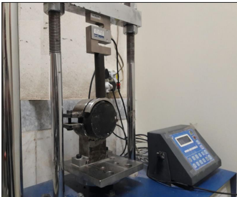
شکل ۴. دستگاه ال پی دی اس موجود در آزمایشگاه روسازی دانشگاه تربیت مدرس
