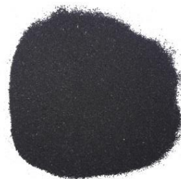
شکل ۱. پودر لاستیک استفاده شده برای اصلاح قیر ۶۰/۷۰
