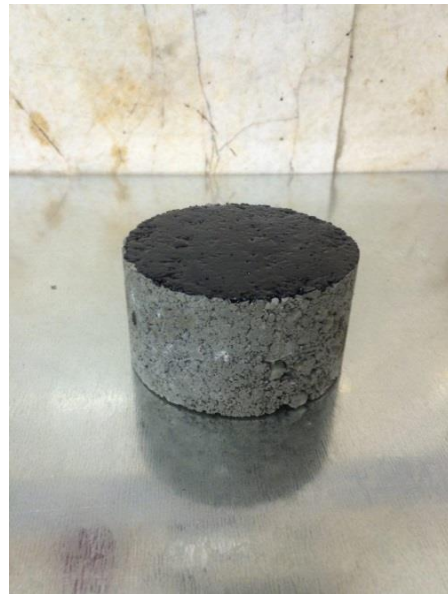
شکل ۲. لایه بتن غلتکی آغشته به اندود سطحی
