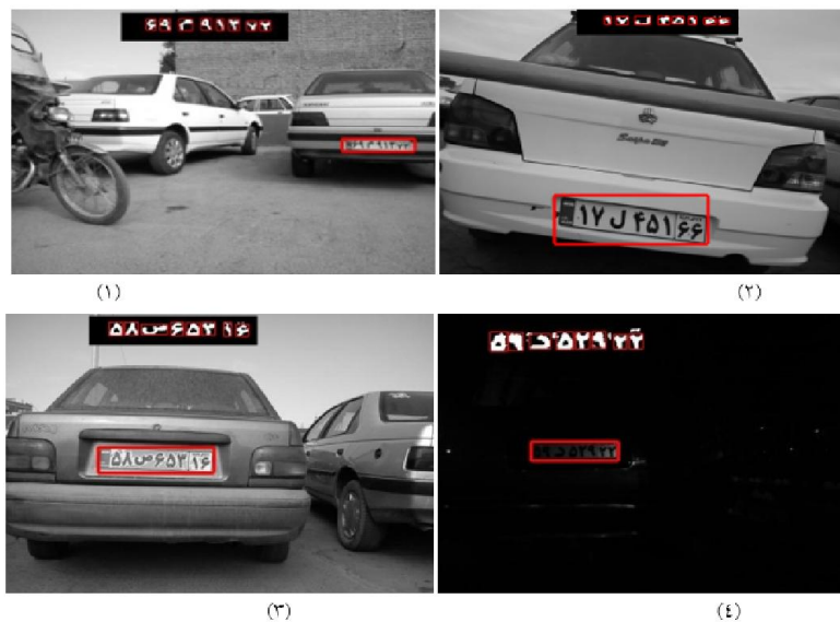
شکل ۱۵. نمونه‌هایی از تصاویر خودروهایی که باعث تشخیص درست سیستم می‌شود (۱) تصویر خودرو از فاصله دور (۲) تصویر خودرو از نزدیک به همراه زاویه زیاد پلاک (۳) کثیفی خیلی زیاد پلاک (۴) تصویربرداری در شب و شدت نوری نامتوازن
