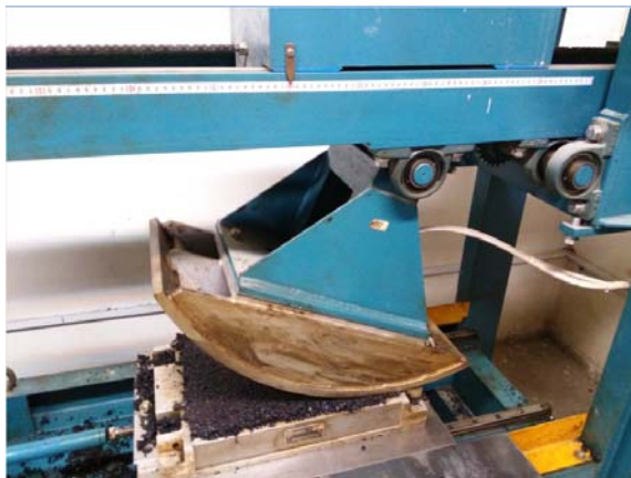
شکل ۲. تراکم نمونه‌های دالی شکل با استفاده از متراکم کننده غلتکی آزمایشگاهی
