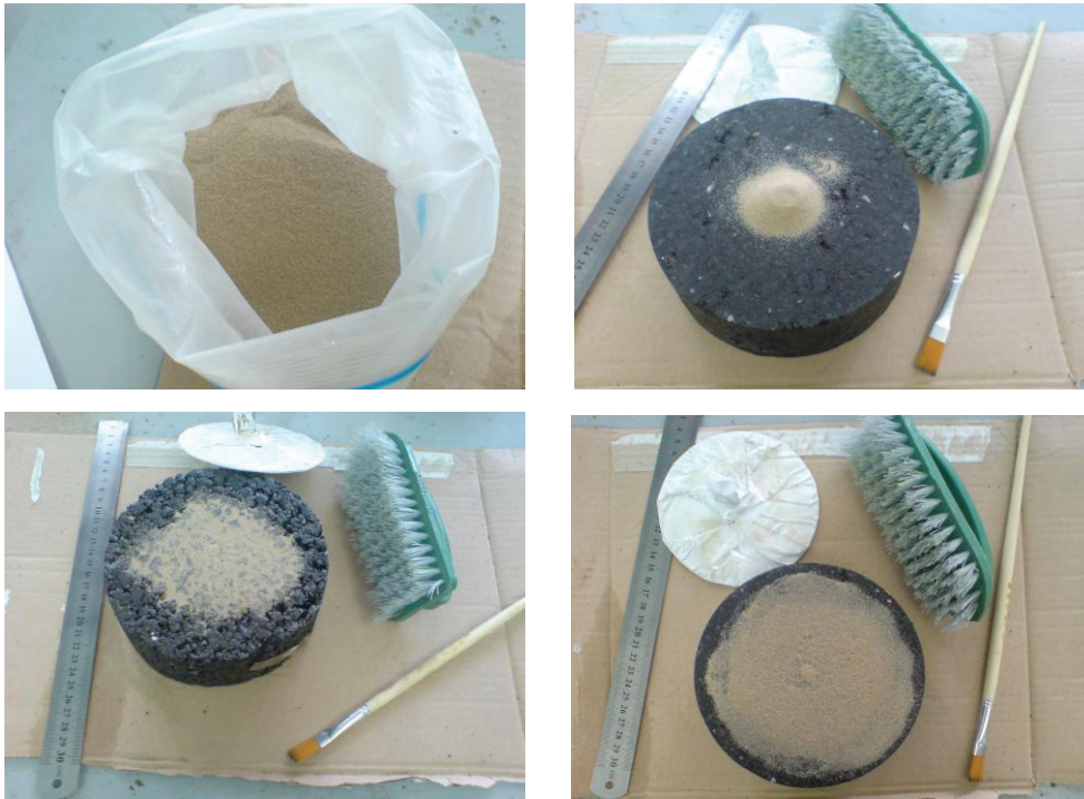
شکل ۶. تهیه ماسه رودخانه‌ای گرد گوشه رده شده از الک شماره ۶۰ و مانده روی الک شماره ۸۰ و پخش کردن حجم معینی از ماسه بر روی سطح نمونه با دانه بندی پیوسته و باز
